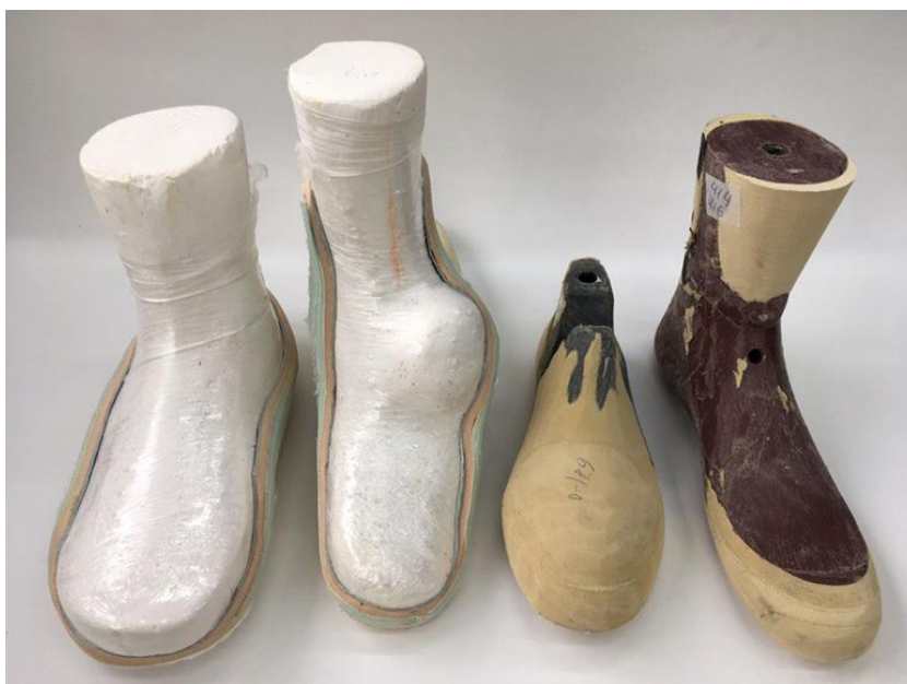
Рисунок 1.7 Индивидуально доработанные и изготовленные колодки
