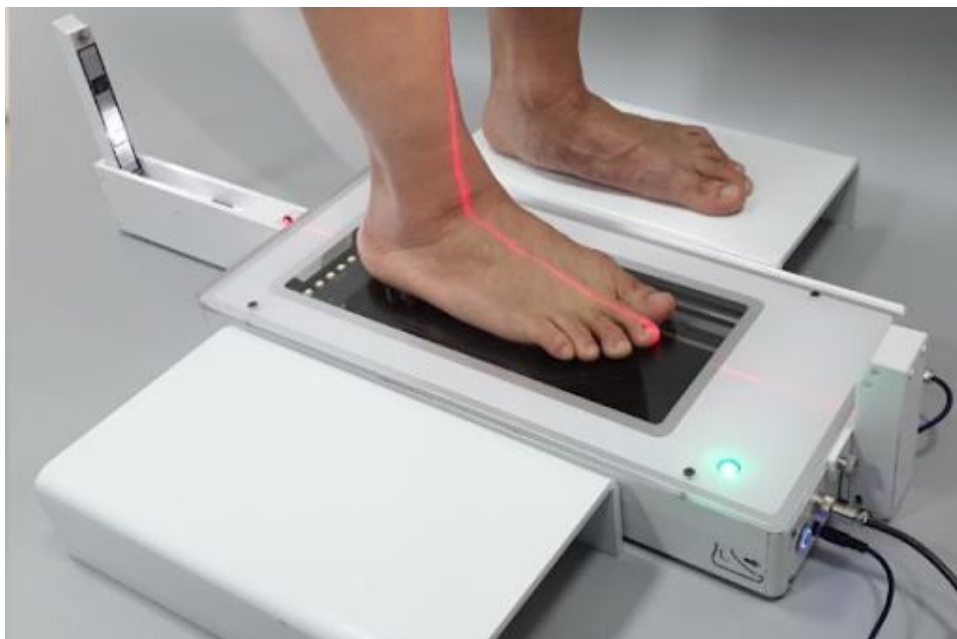
Рисунок 1.6 Бесконтактный обмер стоп с помощью сканера ScanPod3D [102]
