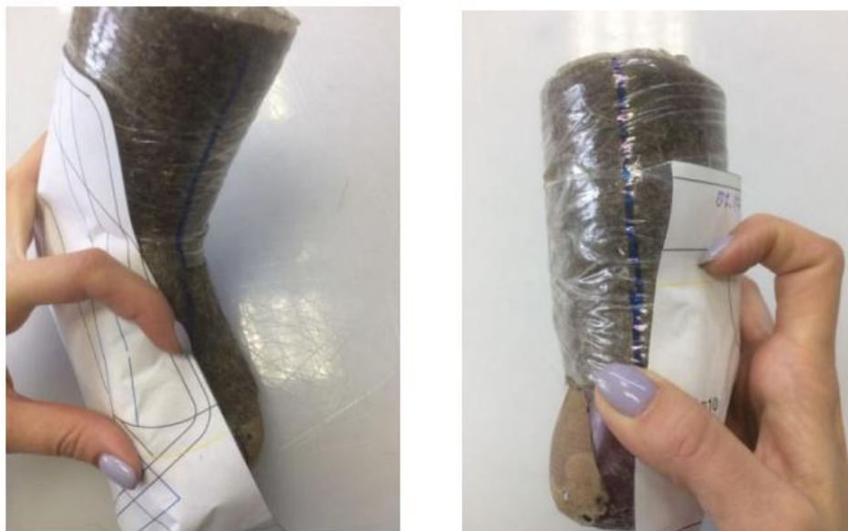
Рисунок 1.12. Положение грунт-модели, созданной в САПР, на колодке [107]
