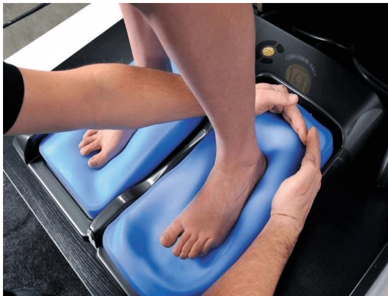
Рисунок 1.10 Формование отпечатков стоп на вакуумных подушках [105]
